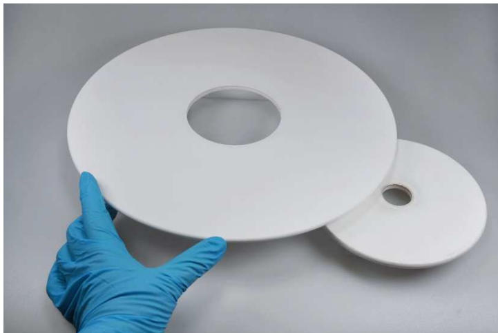
Keramische Rotationsscheibenfilter werden im Projekt in der Behandlung von Abwasserströmen erprobt. Foto: Fraunhofer IKTS
