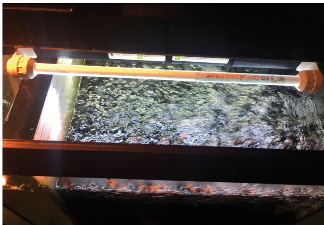
Blick von oben in den Bewegtbett-Filter. Dieser sichert die Aufbereitung des Wassers für die Fische und die Pflanzen. ©Harvey Harbch
